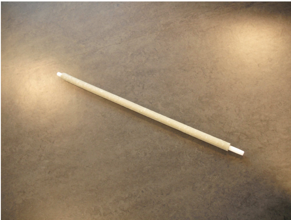
Vaste betonietkolom met peilbuis
