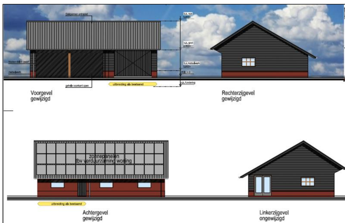
Afbeelding 2.3 Gevelaanzichten bijgebouw met de gewenste uitbreiding (Bron: Bouwkundig Adviesbureau Twente).
