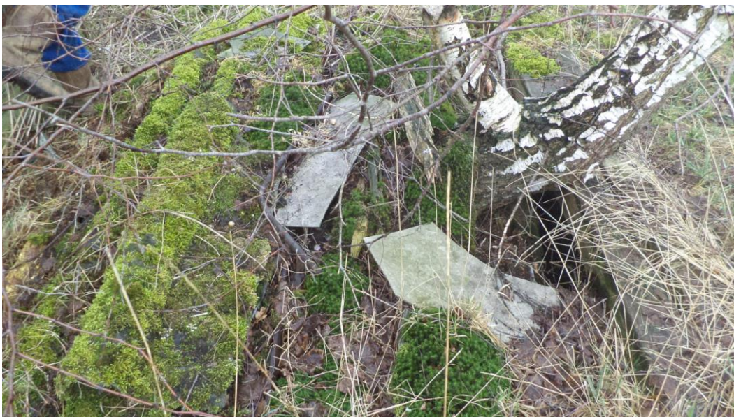
Foto 6: opslag van asbestdakplaten t.p.v. de noordwest gelegen schuur
