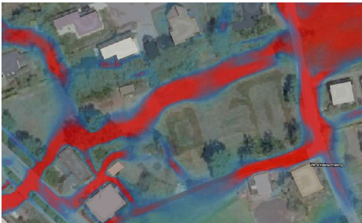
Figuur 22: oppervlakkige stroombaan op Aalvink bij 90 mm in 1 uur, na ontwikkeling percelen. De kaart geeft inzicht in de hoeveelheid water die langs het gebied stroomt, waarbij het volume water toeneemt naarmate de kleur rood wordt.
