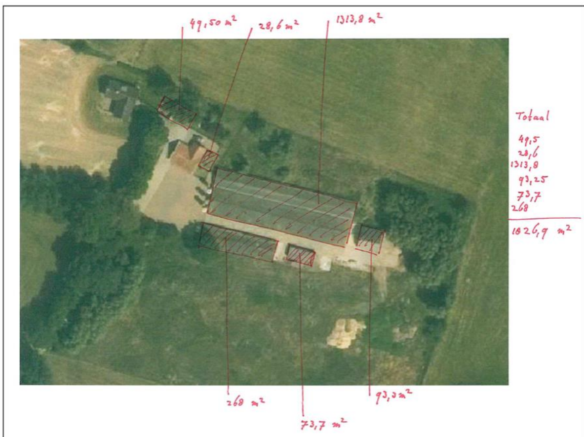
Afbeelding 2.2 In te zetten sloopmeters op het erf Bullenaarsweg 4/4a
