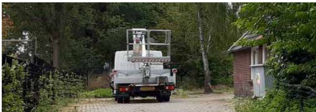
Autohoogwerker gebruikt tijdens het veldonderzoek.
