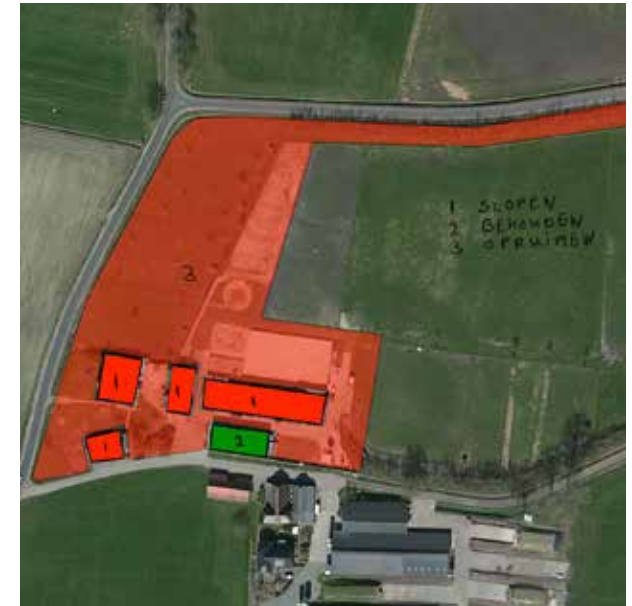
Rood is slopen, opruimen en saneren
