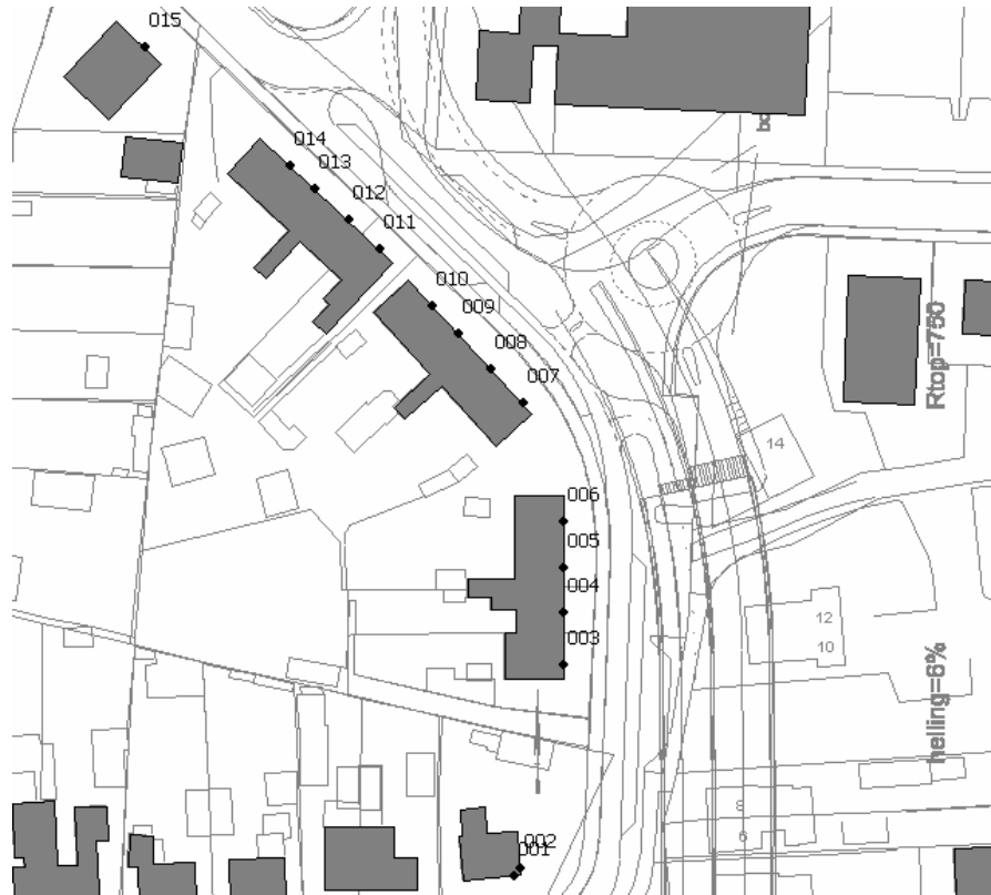
Figuur B2.1: Overzicht waarneempunten noordzijde tunnel
