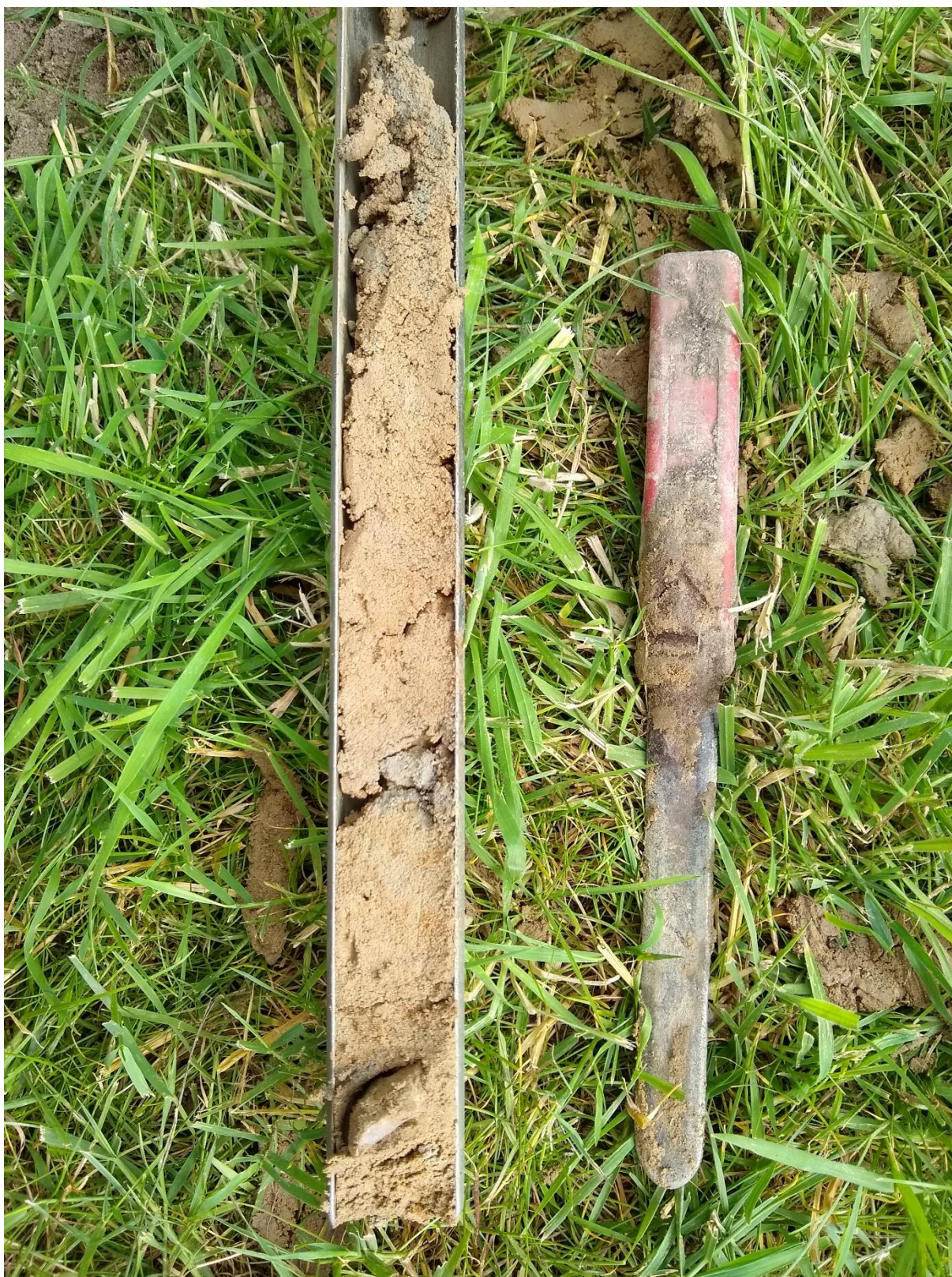
Figuur 4. Foto van de sterk zandige, matig grindige leemlaag vlak boven het niveau waarop boring 7 is gestuit op een compact niveau (circa 160-180 cm –mv).
