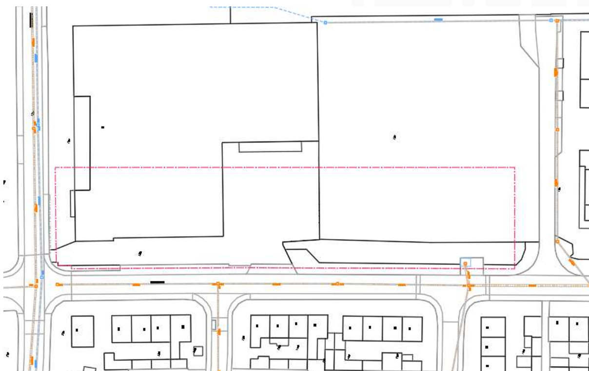
Figuur: Overzicht bestaande riolering
