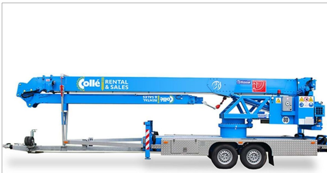
Voorbeeld van een lichte, mobiele kraan. Geschikt voor plaatsen sandwichpanelen.
