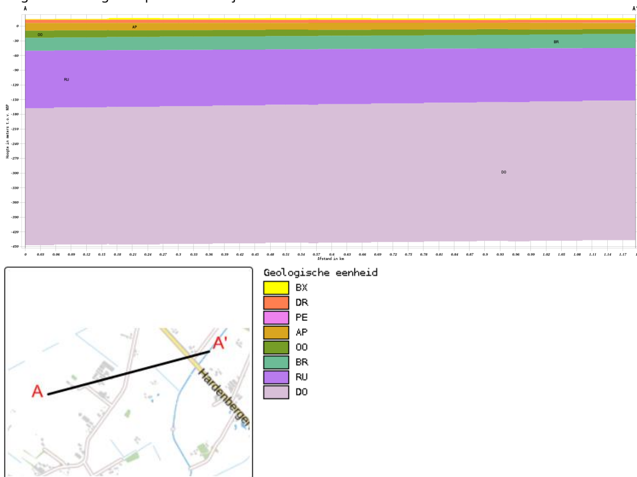
Figuur 1 Geologisch opbouw landelijk model DGM v2.2
