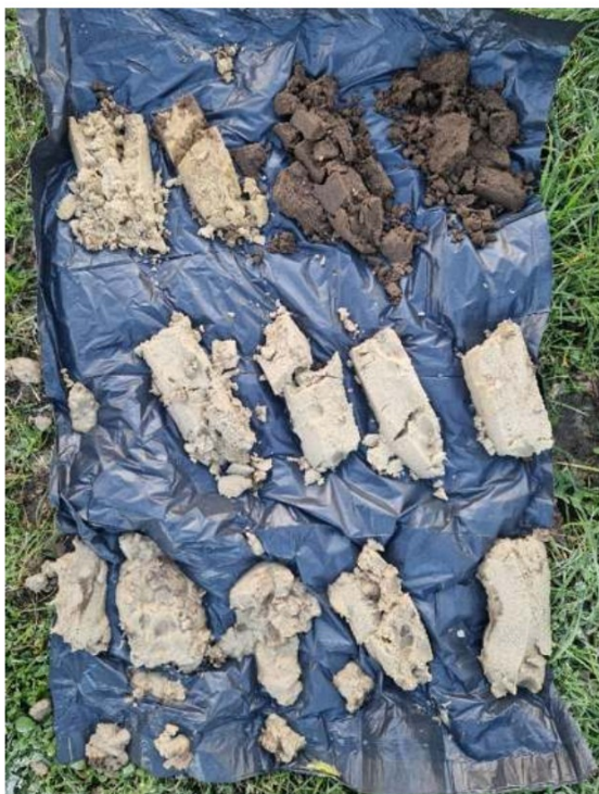
Figuur 3: Het bodemprofiel van de beekerdgrond welke volledig uit zand bestaat. De bovenste 20 cm bestaat heeft zichtbaar een hoger organisch stofgehalte.
