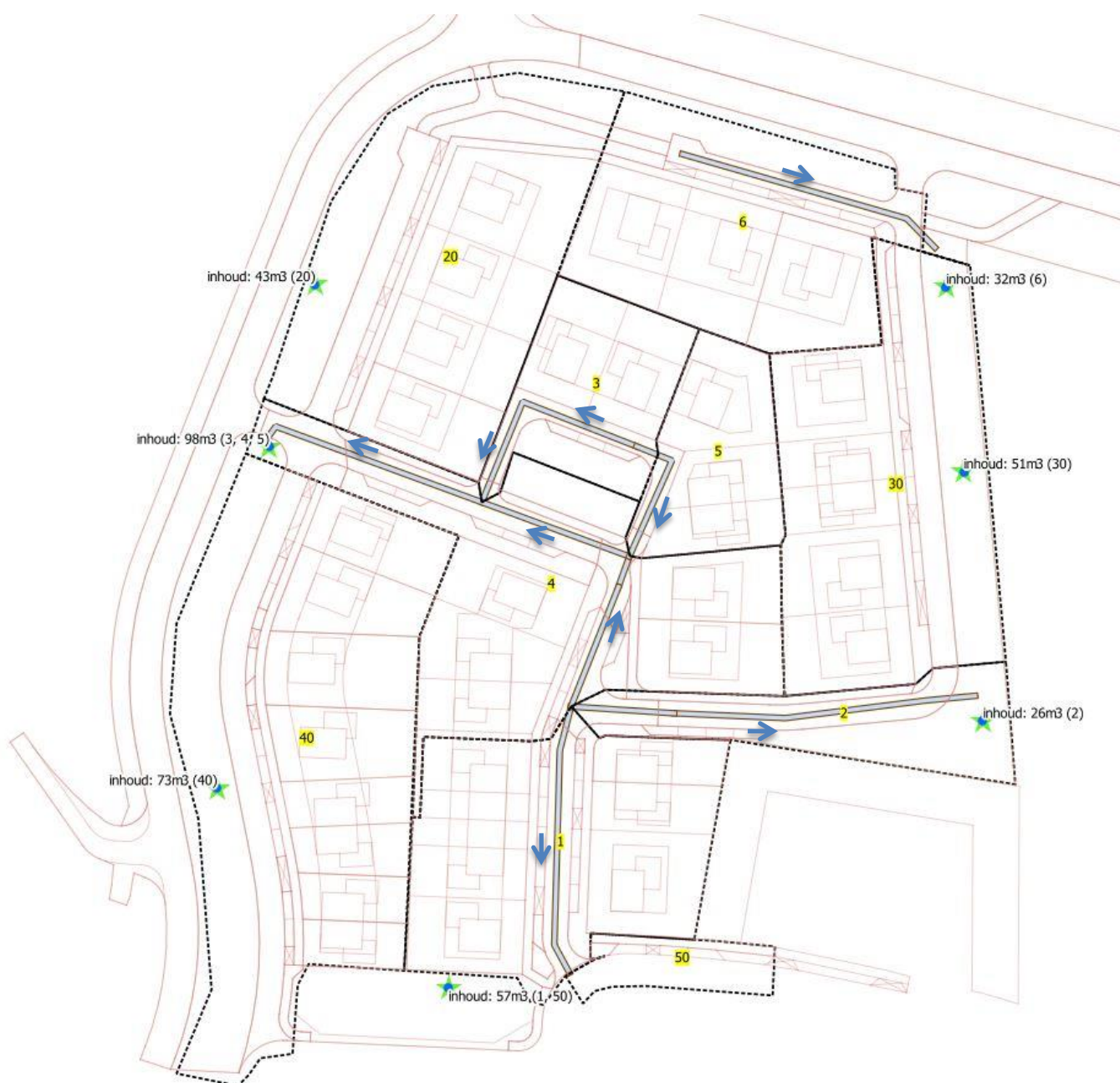
Figuur 5.1: Indicatieve locaties (groene ster) met benodigde inhoud van de bergingsvoorzieningen (met tussen haakjes het nummer van het afstroomoppervlak dat uitkomt op de afvoergoot dan wel rechtstreeks op de bergingsvoorziening)
