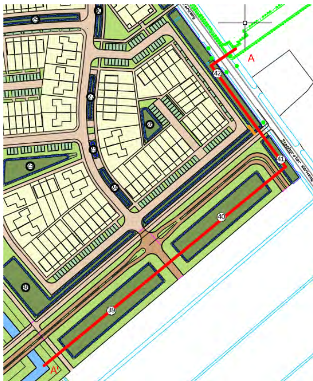
Afbeelding 18: voorstel afvoer noodoverloop De Slagen fase 2 (rode lijn) via De Slagen fase 3 (op oud ontwerp waarbij wadi 39 t/m 42 nu wadi 30, 31, 32 en 34 betreffen).
