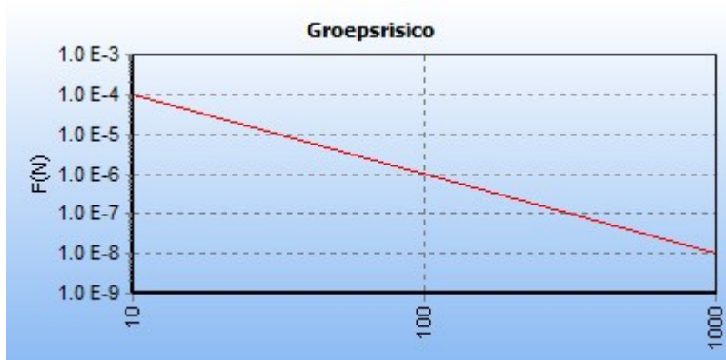
4.1 Figuur 4.1: FN curve voor 8727_leiding-N-520-15-deel-1 van N.V. Nederlandse Gasunie voor de kilometer tussen stationing 1350.00 en stationing 2350.00
