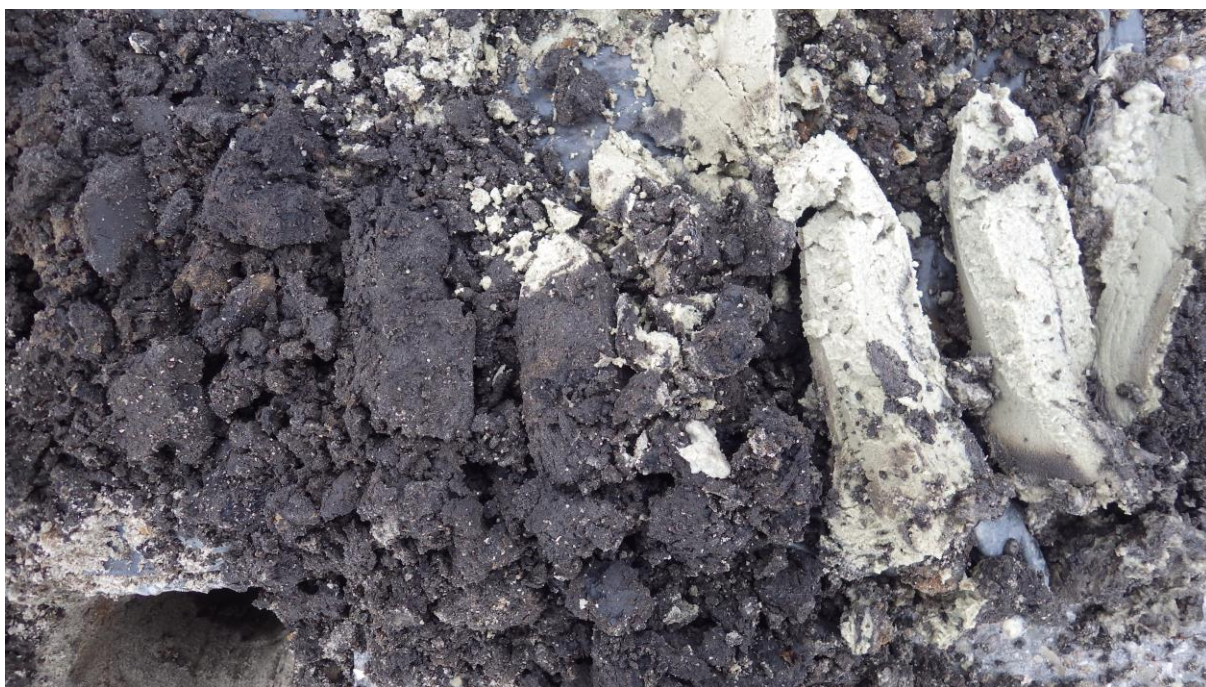
Boring 1: Overgang naar dekzand (C-horizont)
