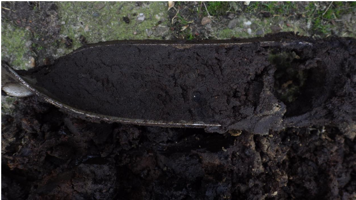
Boring 6: Sterk humeuze bodemlaag
