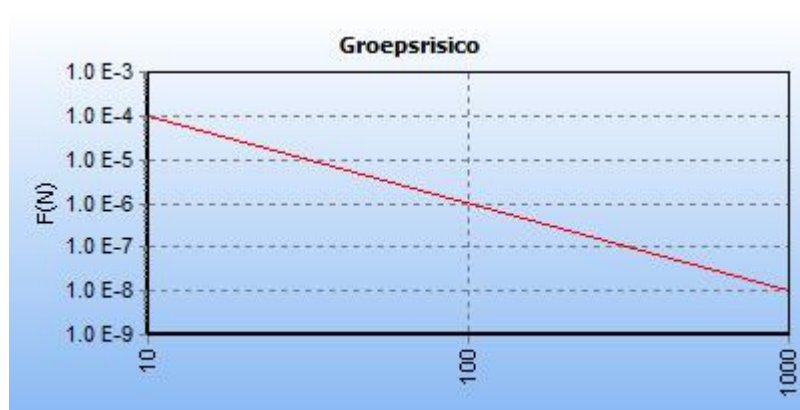
Figuur 5.1 FN curve nieuwe situatie voor 8302_leiding-N-550-40-deel-1 van N.V. Nederlandse Gasunie voor de kilometer tussen stationing 1150.00 en stationing 2150.00
