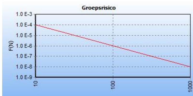
Figuur 5.1 FN curve bestaande situatie voor 8302_leiding-N-550-40-deel-1 van N.V. Nederlandse Gasunie voor de kilometer tussen stationing 1150.00 en stationing 2150.00
