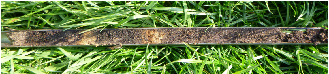
Figuur 10: Rouveen, Oude Rijksweg: De meest kenmerkende bodemopbouw binnen het plangebied met een toplaag van moerig zand (rechts) op een pakket dat bestaat uit zand met daarin brokken veen van uiteenlopende veraardingsgraad (links van het midden), met daaronder het geelgrijze dekzand van de C-horizont (geheel links).
