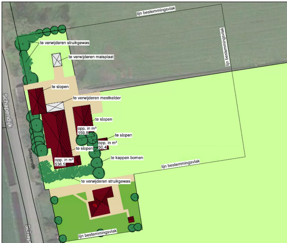
Afbeelding 1.1 Sloopopgave Schapendijk 27 (Bron: Huls Architecten)
