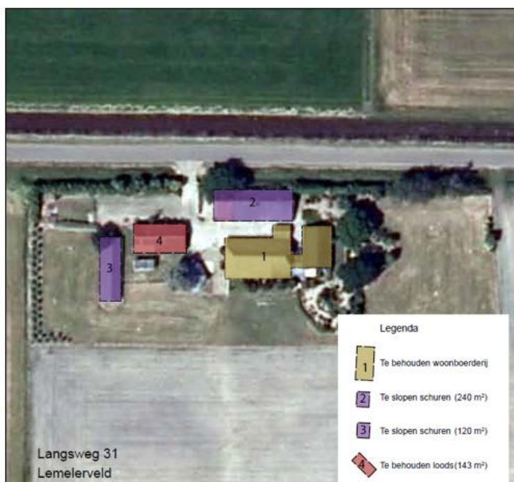
Figuur 3.3: Te slopen en te behouden bebouwing op de locatie aan de Langsweg (Bron: Eelerwoude)
