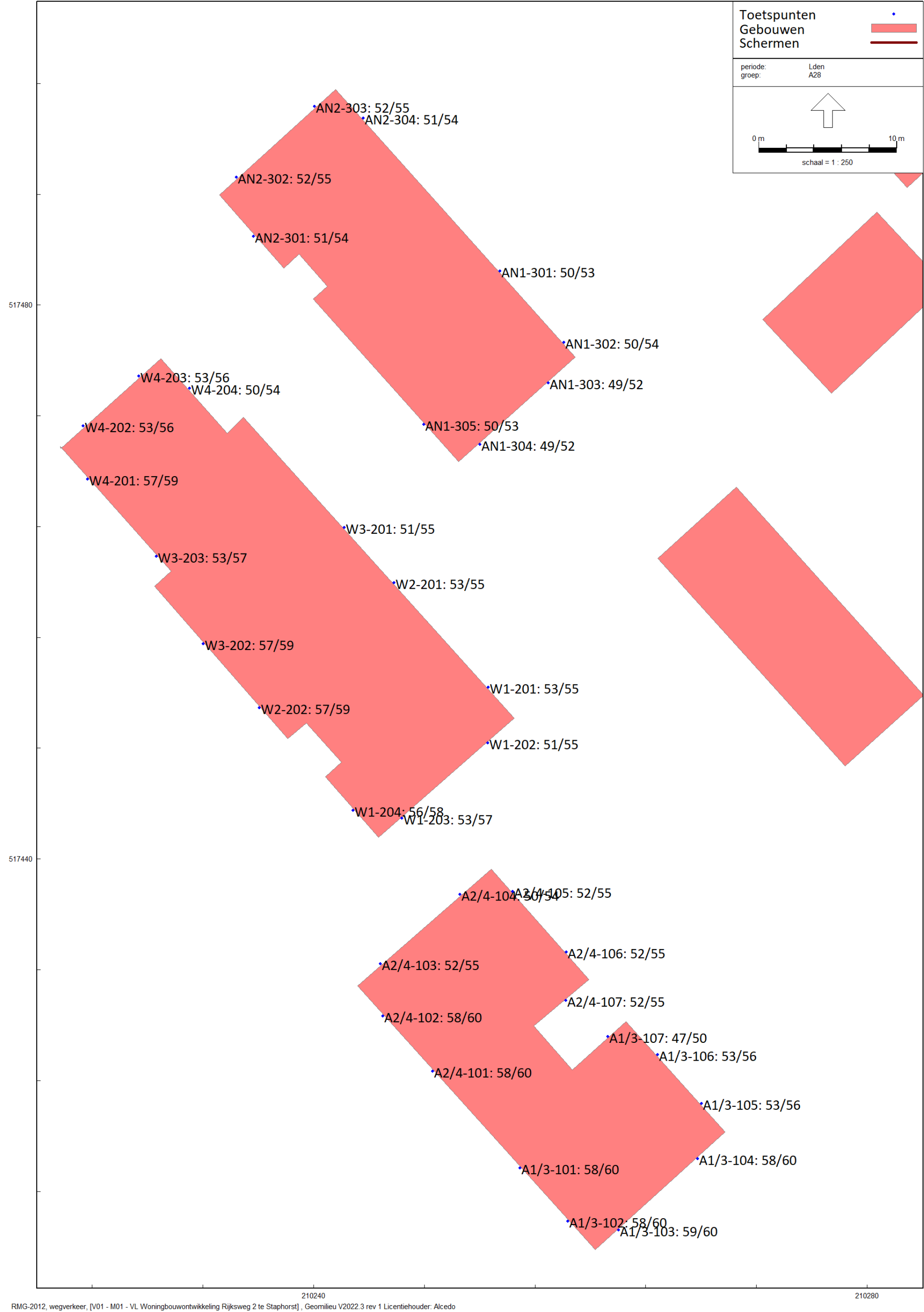
Figuur 4 Geluidsbelastingen vanwege wegverkeer op de Rijksweg A28 exclusief 2 tot en met 4 dB correctie conform artikel 110g Wgh Beoordelingshoogte 1,5 en 4,5 meter Toe te passen correctie bij een geluidsbelasting van: 56 dB;-3 dB, 57 dB;-4dB en overig -2 dB
