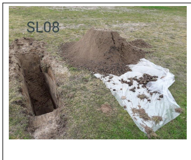
Foto: Inspectiesleuf SL08
