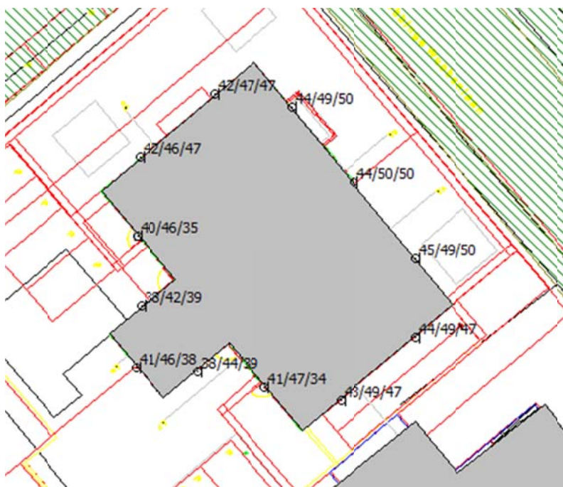
Figuur 4.4 Geluidsbelasting ten gevolge van de spoorlijn per waarneempunt op 1,5 m, 4,5 m en 7,5 m hoogte
