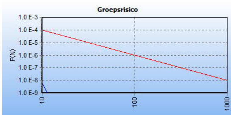
5.3 Figuur 5.3 FN curve voor 8686_leiding-N-550-41-deel-1 van N.V. Nederlandse Gasunie voor de kilometer tussen stationing 0.00 en stationing 1000.00
