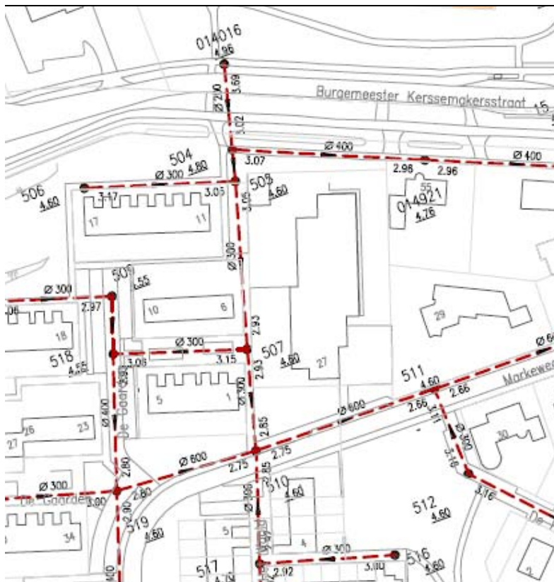
Figuur 3.2 Huidige rioleringssituatie Markeweg 25-27
