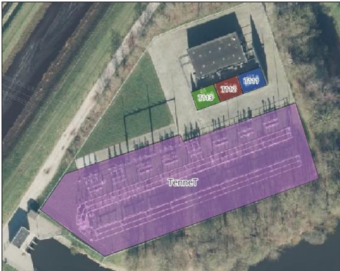
Figuur 3.2 Indeling bestaande hoogspanningsschakelstation
