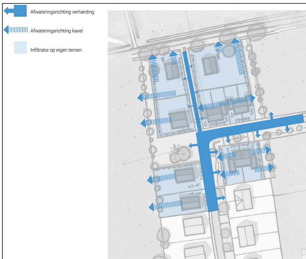
Afwatering in het plangebied (bron: SAB, Landschappelijke en stedenbouwkundige uitgangspunten).
