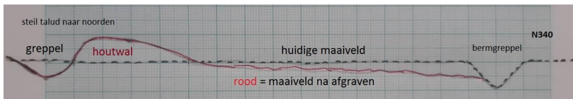
Figuur 1. Glooiend talud 1:10 vanuit bermgreppel en realisatie van eenzijdig begreppelde houtwal. Een dergelijke inrichting draagt in sterke mate bij aan de toekomstige biodiversiteit in het nieuwe bos (1 cm = 1 m).
