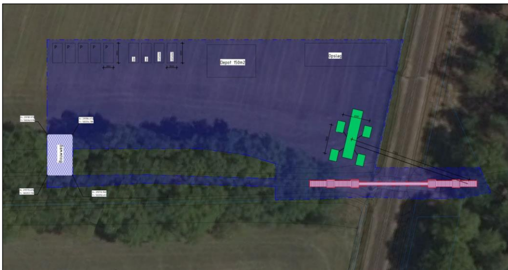
Figuur 2. Het werkterrein en de inrichting ervan. In rood de locatie van de spoorbrug. Links de bouwweg door de houtsingel.
