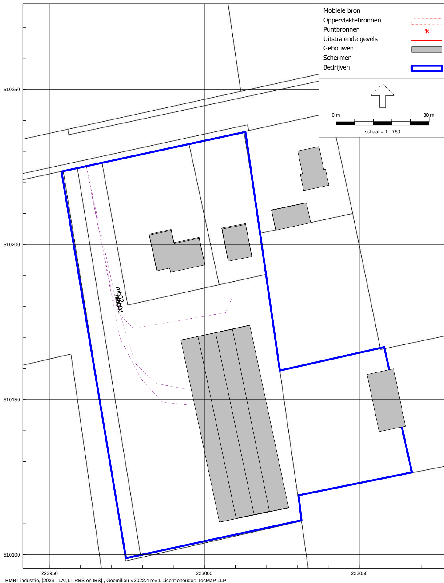
figuur 5d Overzicht rekenmodel met positie geluidbronnen
