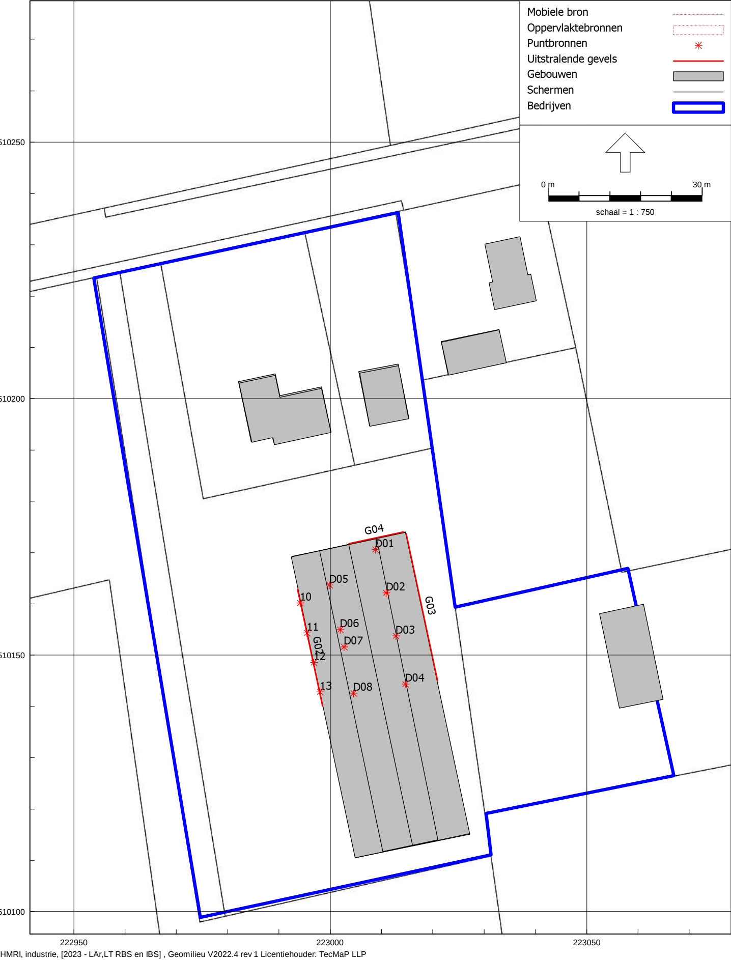
figuur 5a Overzicht rekenmodel met positie geluidbronnen / vast opgestelde bronnen /
