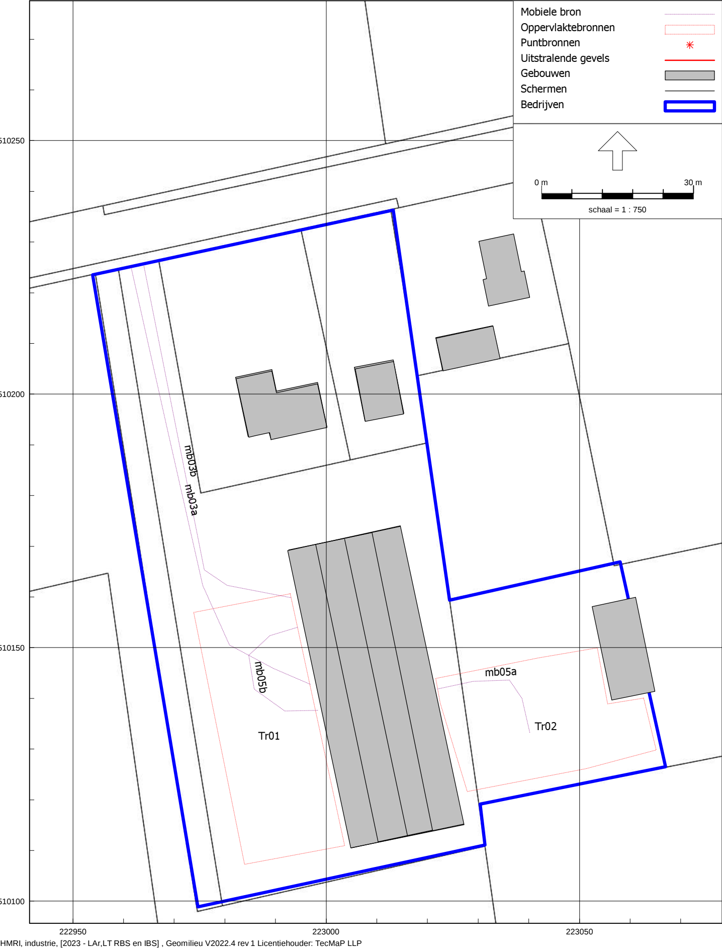
figuur 5c Overzicht rekenmodel met positie geluidbronnen / tractoren /
