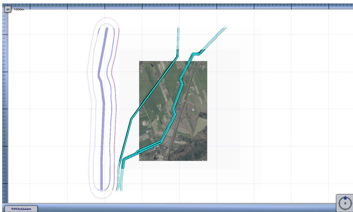
3.2 Figuur 3.2 Plaatsgebonden risico voor 8315_leiding-A-502-deel-1 van N.V. Nederlandse Gasunie
