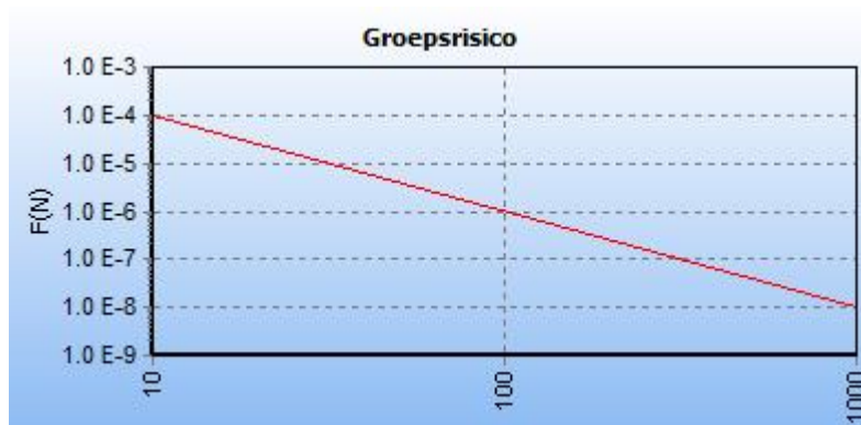
Afbeelding 6 fN-curve buisleiding A-661-deel-1, huidige situatie
