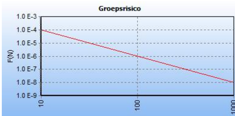
Afbeelding 11 fN-curve buisleiding A-619-deel-1, huidige situatie
