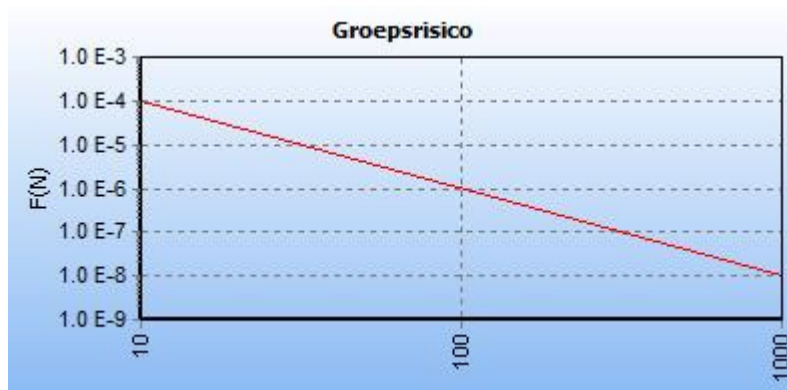
Afbeelding 26 fN-curve buisleiding A-605-deel-1, huidige situatie
