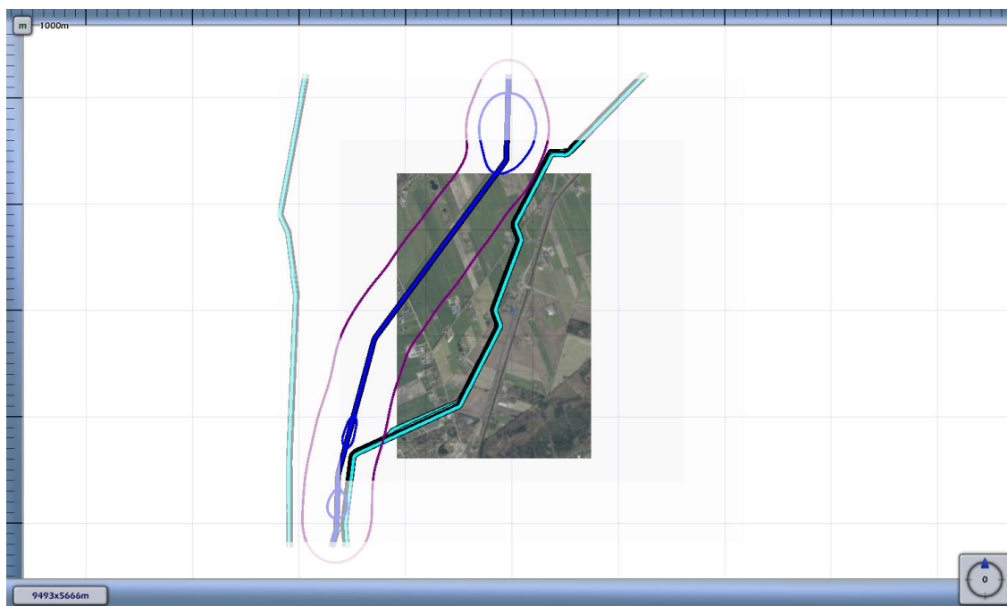
3.4 Figuur 3.4 Plaatsgebonden risico voor 8315_leiding-A-509-deel-1 van N.V. Nederlandse Gasunie
