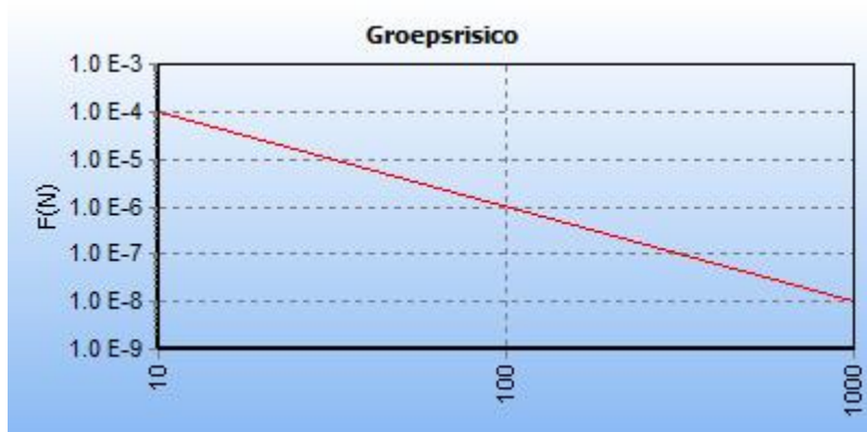
5.8 Figuur 5.8 FN curve voor 8315_leiding-A-605-deel-1 van N.V. Nederlandse Gasunie voor de kilometer tussen stationing 870.00 en stationing 1870.00
