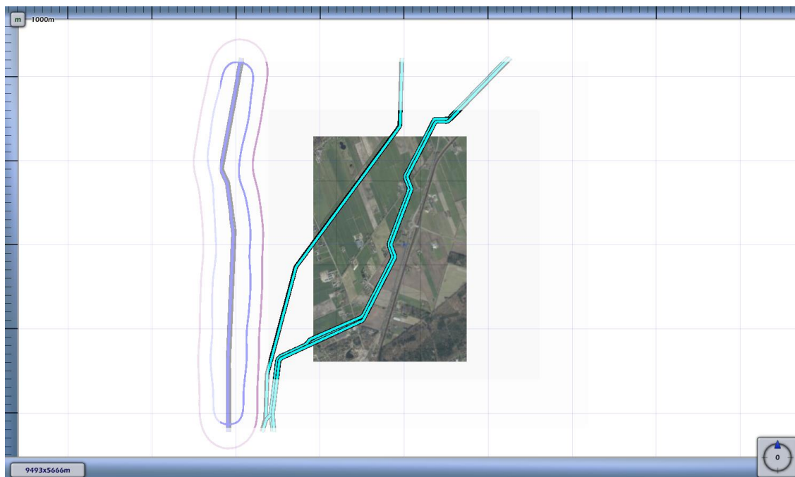
3.2 Figuur 3.2 Plaatsgebonden risico voor 8315_leiding-A-502-deel-1 van N.V. Nederlandse Gasunie
