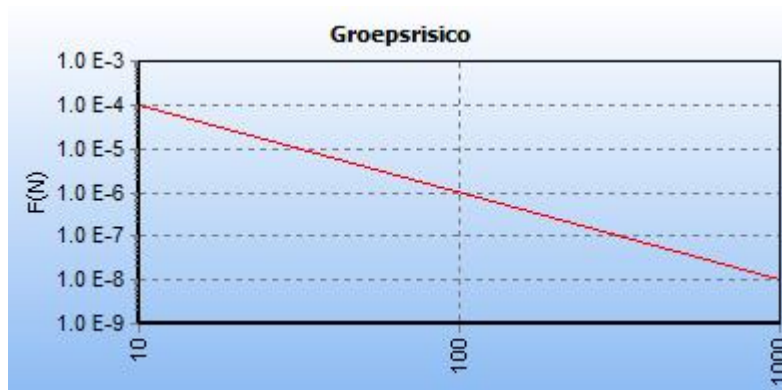
Afbeelding 21 fN-curve buisleiding A-519-deel-1, huidige situatie
