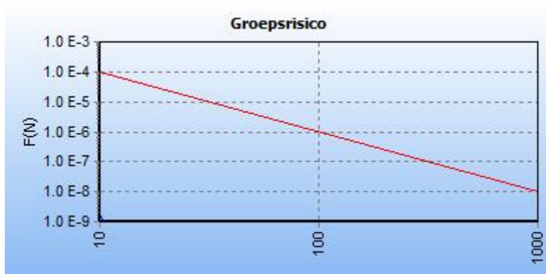
5.10 Figuur 5.10 FN curve voor 8315_leiding-A-661-deel-1 van N.V. Nederlandse Gasunie voor de kilometer tussen stationing 2670.00 en stationing 3670.00
