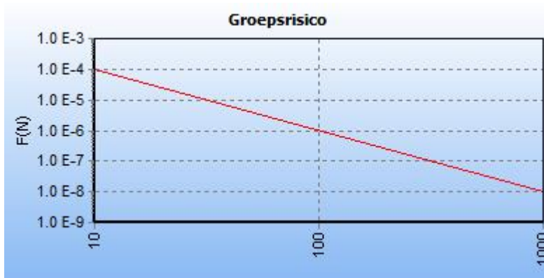
Afbeelding 16 fN-curve buisleiding A-516-deel-1, huidige situatie
