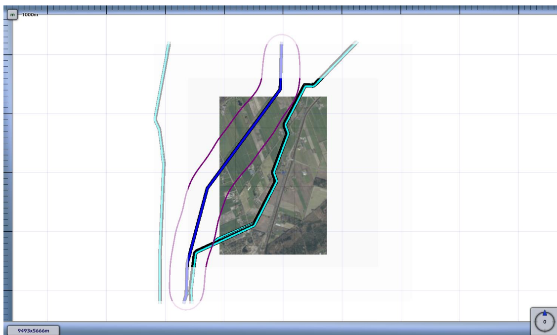
3.4 Figuur 3.4 Plaatsgebonden risico voor 8315_leiding-A-509-deel-1 van N.V. Nederlandse Gasunie
