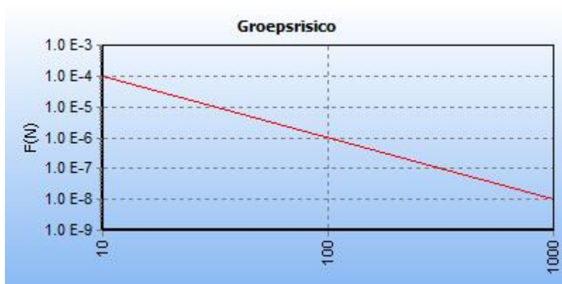
5.5 Figuur 5.5 FN curve voor 8315_leiding-A-514-deel-1 van N.V. Nederlandse Gasunie voor de kilometer tussen stationing 0.00 en stationing 0.00
