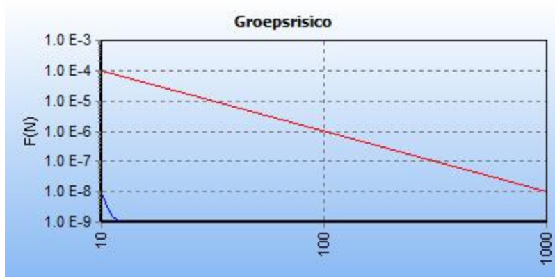
5.10 Figuur 5.10 FN curve voor 8315_leiding-A-661-deel-1 van N.V. Nederlandse Gasunie voor de kilometer tussen stationing 2670.00 en stationing 3670.00
