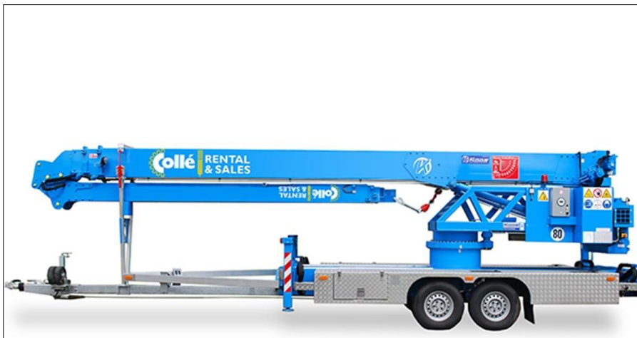
Voorbeeld van een lichte, mobiele kraan. Geschikt voor plaatsen dakpannen, dakplaten en damwandplaten.
