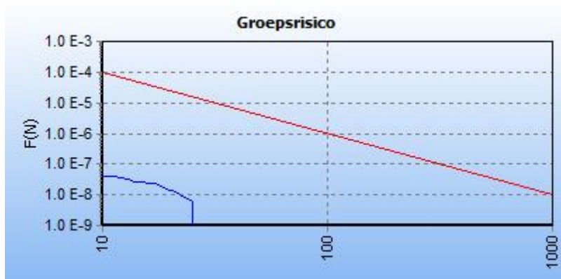
5.5 Figuur 5.5 FN curve voor 8317_leiding-A-522-deel-1 van N.V. Nederlandse Gasunie voor de kilometer tussen stationing 1290.00 en stationing 2290.00
