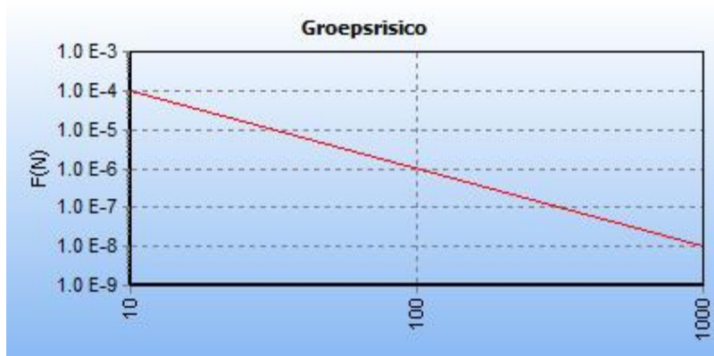
5.7 Figuur 5.7 FN curve voor 8317_leiding-A-529-deel-1 van N.V. Nederlandse Gasunie voor de kilometer tussen stationing 650.00 en stationing 1650.00
