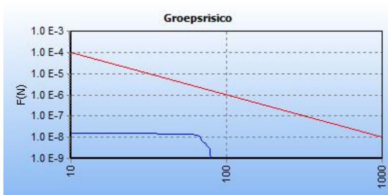
5.8 Figuur 5.8 FN curve voor 8317_leiding-A-549-deel-1 van N.V. Nederlandse Gasunie voor de kilometer tussen stationing 660.00 en stationing 1660.00
