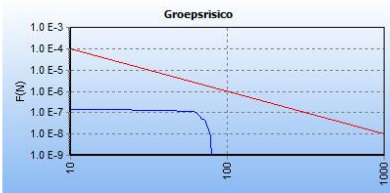
5.2 Figuur 5.2 FN curve voor 8317_leiding-A-506-deel-1 van N.V. Nederlandse Gasunie voor de kilometer tussen stationing 650.00 en stationing 1650.00
