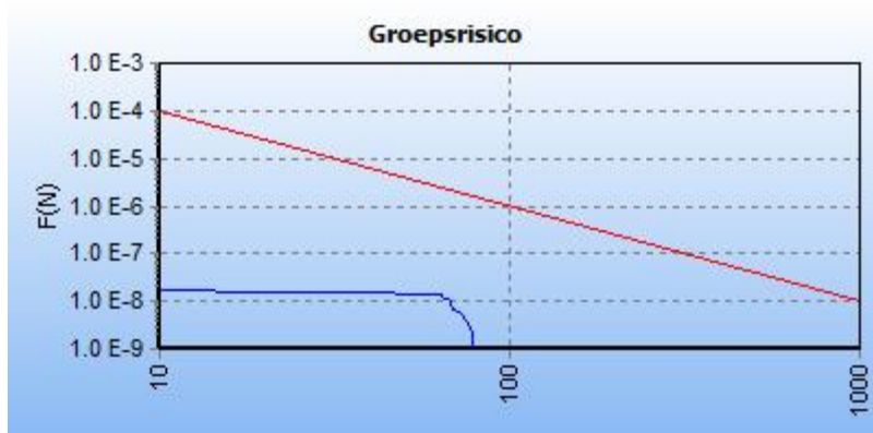
5.10 Figuur 5.10 FN curve voor 8317_leiding-A-648-deel-1 van N.V. Nederlandse Gasunie voor de kilometer tussen stationing 650.00 en stationing 1650.00
