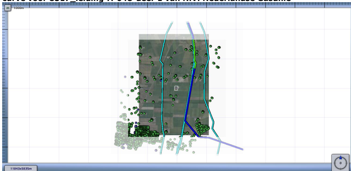
Figuur 4.10 Kilometer leiding behorende bij de maximale overschrijding van de FN-curve voor 8317_leiding-A-648-deel-1 van N.V. Nederlandse Gasunie
