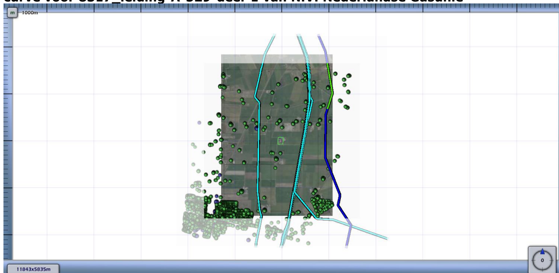
Figuur 4.7 Kilometer leiding behorende bij de maximale overschrijding van de FN-curve voor 8317_leiding-A-529-deel-1 van N.V. Nederlandse Gasunie
