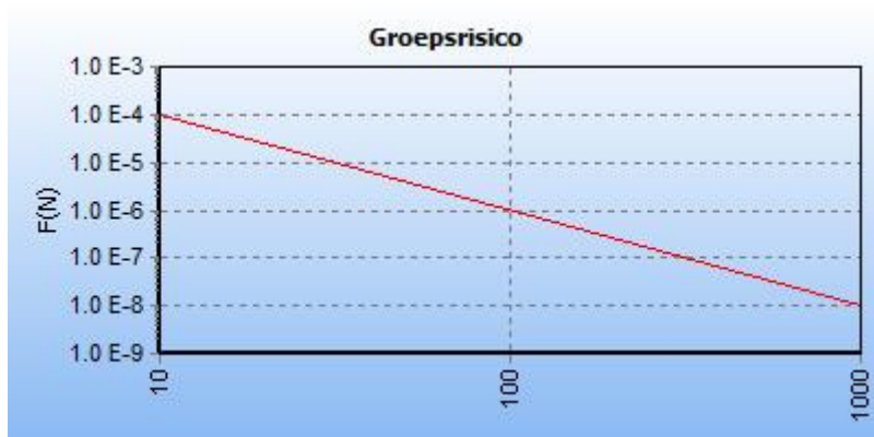
5.8 Figuur 5.8 FN curve voor 8317_leiding-A-549-deel-1 van N.V. Nederlandse Gasunie voor de kilometer tussen stationing 660.00 en stationing 1660.00
