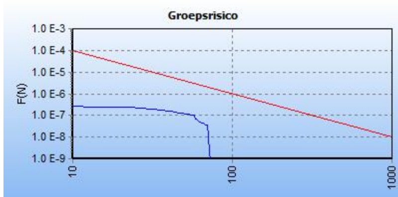
5.4 Figuur 5.4 FN curve voor 8317_leiding-A-511-deel-1 van N.V. Nederlandse Gasunie voor de kilometer tussen stationing 1270.00 en stationing 2270.00
