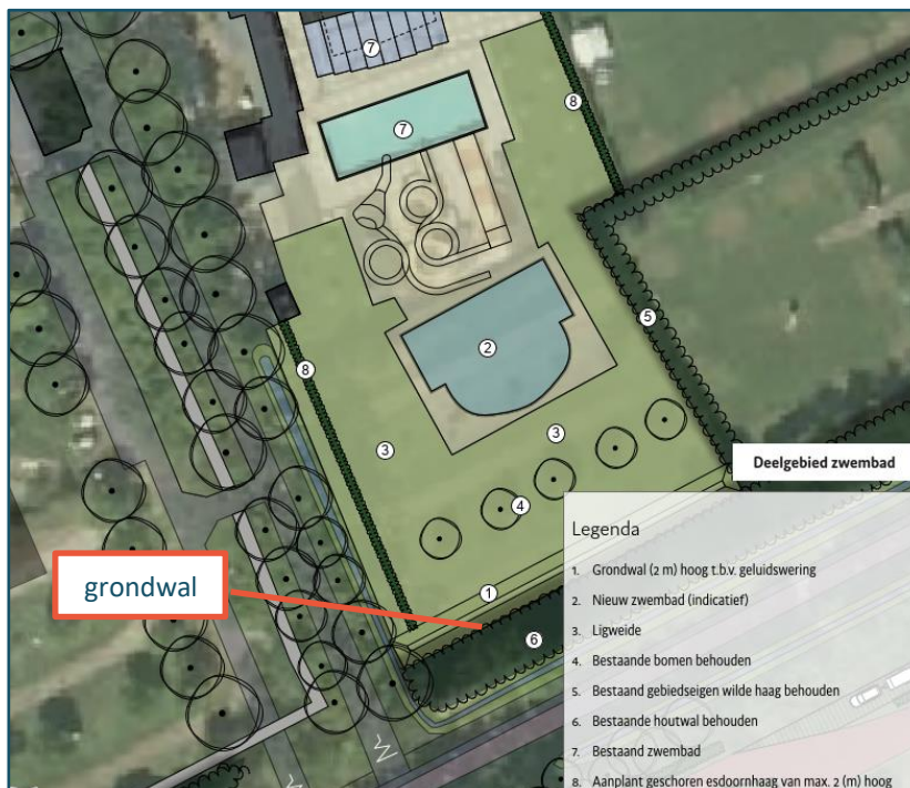
Figuur 5 Grondwal ter plaatse van de zonneweide.
