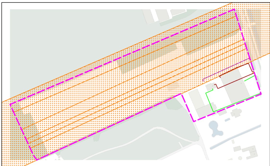
Figuur 11. Uitsnede van de KLIC-kaart. Het oranje gearceerde deel betreft dat deel van de ondergrond dat tot dieptes van 4,2-4,6 m +NAP (1,8-2,4 m -Mv) is vergraven.
