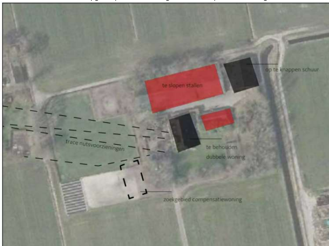
Afbeelding 2.1 Te slopen bebouwing Arrierfliërweg 8 (Bron: De Erfontwikkelaar)
