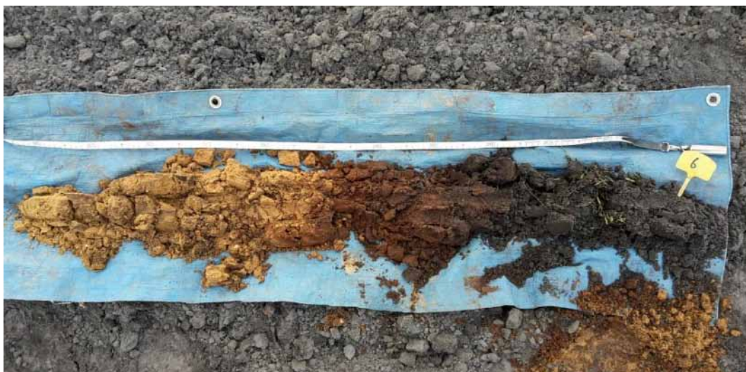
Afbeelding 18. Een foto van één van de bodemboringen verricht en geanalyseerd door de ecohydroloog om de ecologisch hoogst haalbare natuurlaan te benoemen. Daarnaast zijn peilbuizen gebruikt om de analyse uit te voeren.
