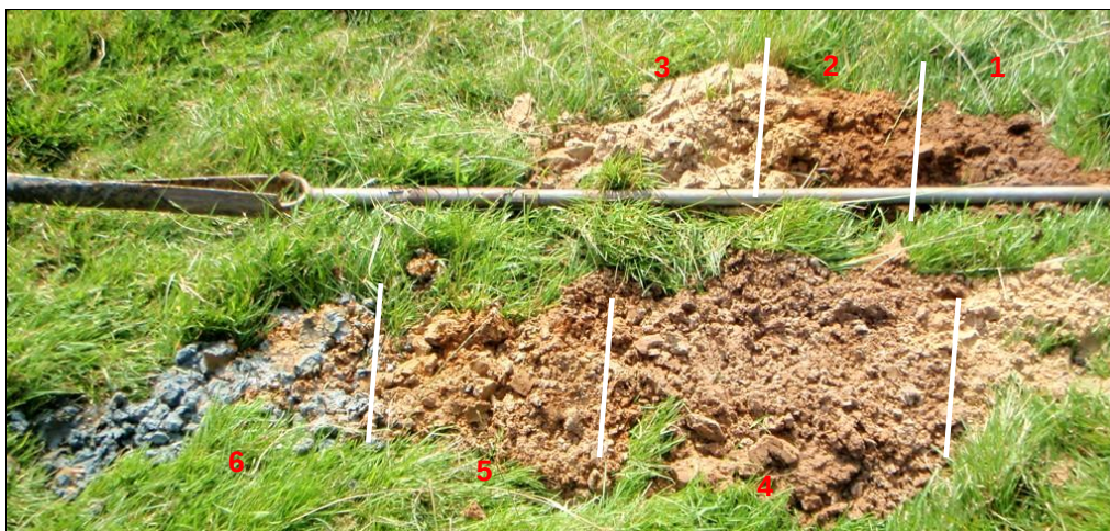
Afbeelding 9. Beeld van boring 5; 1: bouwvoor, 2: bruingeel zand, 3: geel zand, 4: zand met roestbrokken, 5: bruingeel zand, 6: blauw zand
