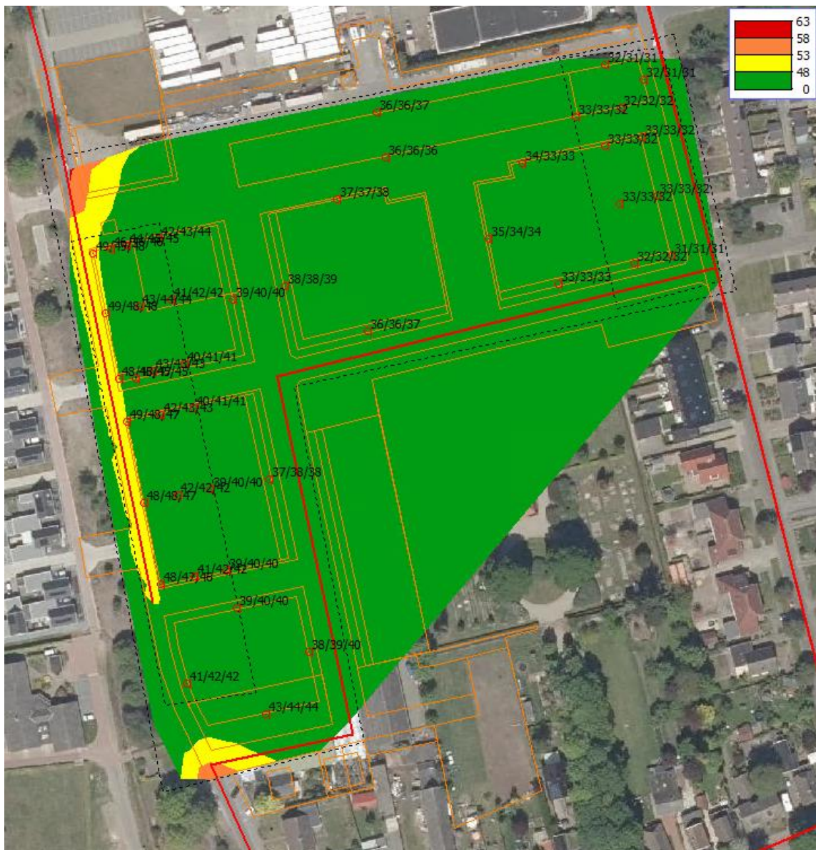
Figuur 4-6 Geluidbelasting vanwege de Haven Oost op de geplande. Geluidbelasting is inclusief correctie artikel 3.4 RMG 2012. Contouren zijn berekend op 4,5m hoogte.
