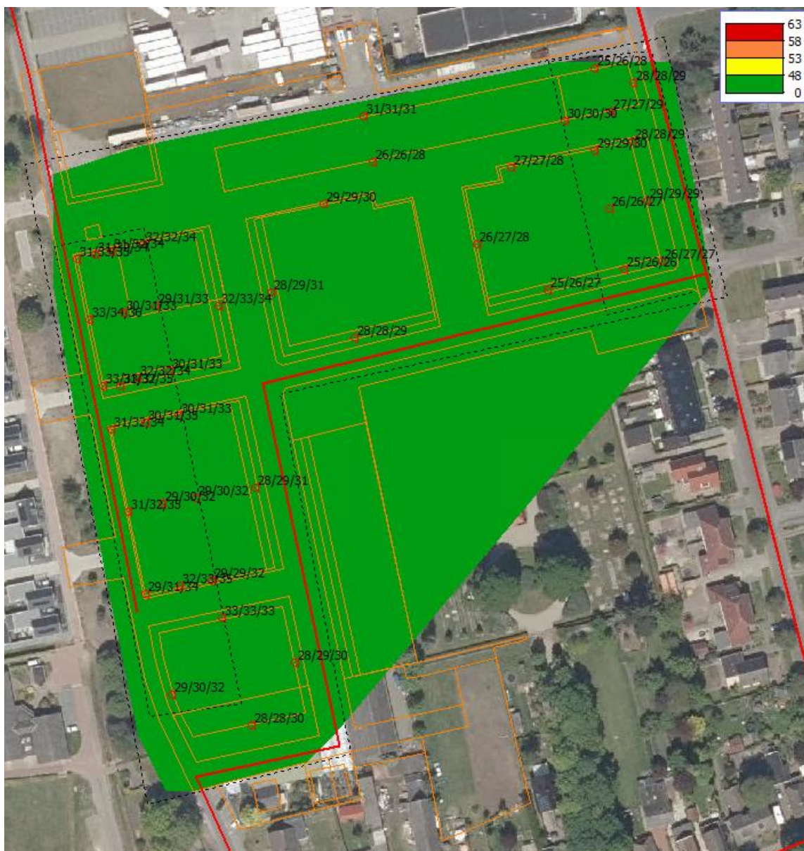
Figuur 4-1 Geluidbelasting vanwege de Schurinkstraat op de geplande woningen. Geluidbelasting is inclusief correctie artikel 3.4 RMG 2012. Contouren zijn berekend op 4,5m hoogte.
