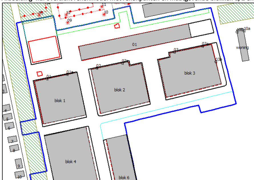
Afbeelding 4.1: overzicht rekenmodel met rekenpunten en maatgevende blokken 1, 2 en 3
