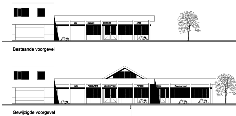
Afbeelding 3.2 Bestaande voorgevel en impressie nieuwe voorgevel
