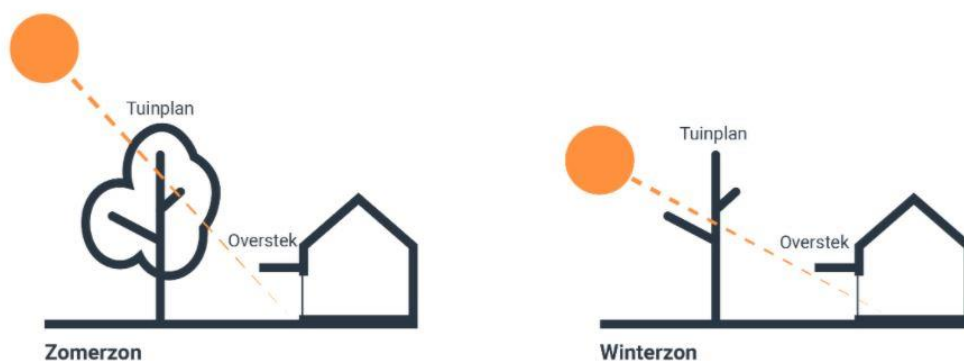
Figuur 9 Schematische weergave mogelijkheid voor zonwering in zomer
