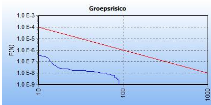
Figuur 5.1 FN curve voor 7281_leiding-N-528-21-deel-1 van N.V. Nederlandse Gasunie voor de kilometer tussen stationing 1810.00 en stationing 2810.00
