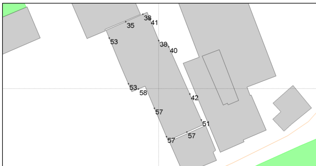
Figuur 2 Hoogst berekende geluidbelasting vanwege de N342 inclusief aftrek conform artikel 110g Wgh
