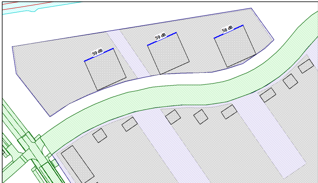
Benodigde hogere waarde per gevel (4 e verdieping), ten gevolge van de spoorlijn Bad-Bentheim
