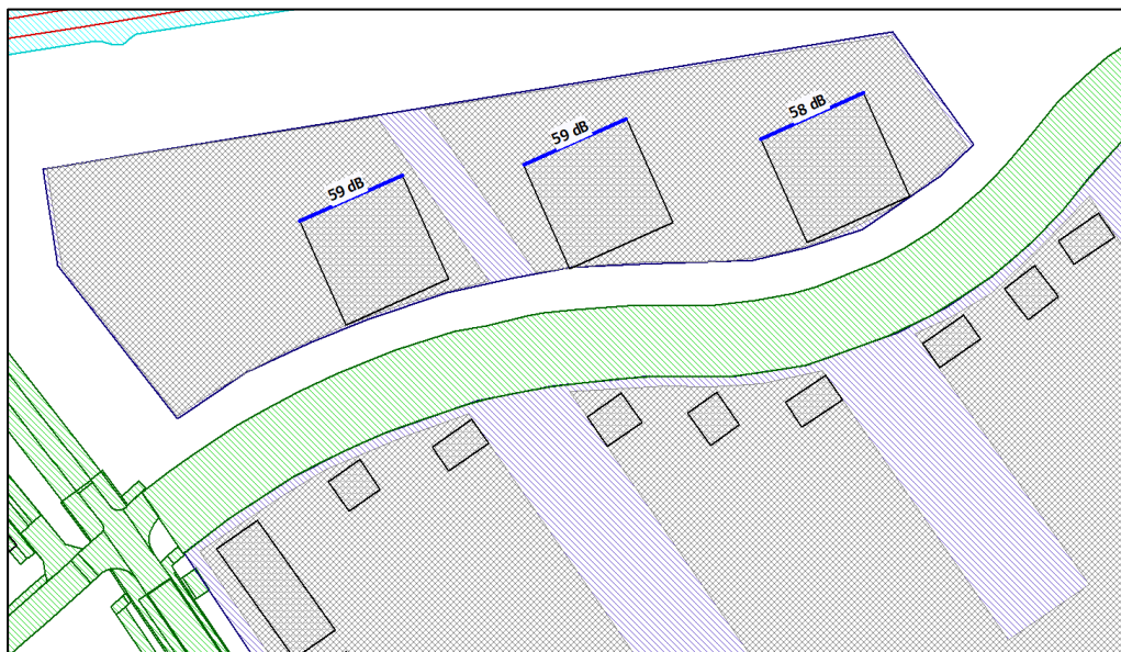
Benodigde hogere waarde per gevel, ten gevolge van de spoorlijn Bad-Bentheim
