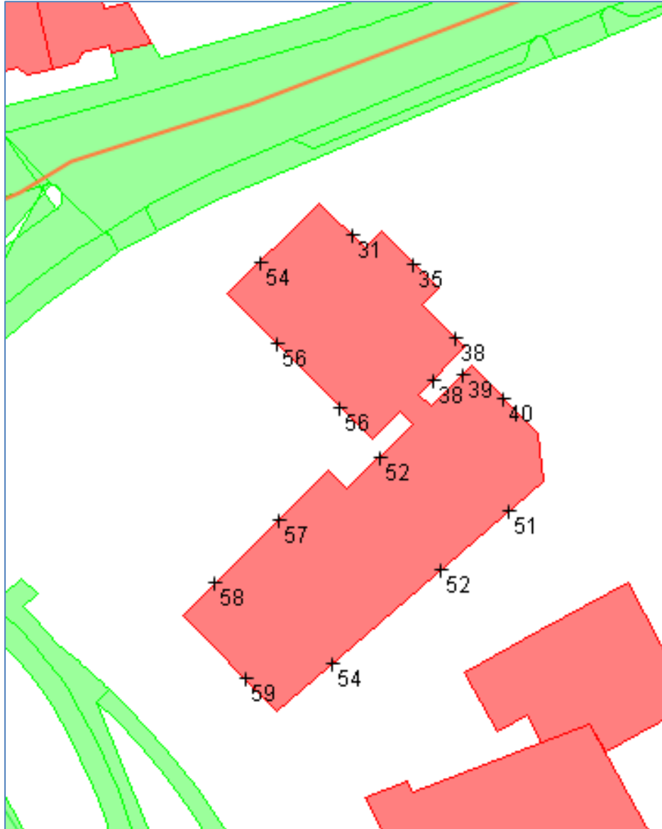
Figuur 2 Hoogst berekende geluidbelasting vanwege de Spoorstraat inclusief aftrek conform artikel 110 g Wgh
