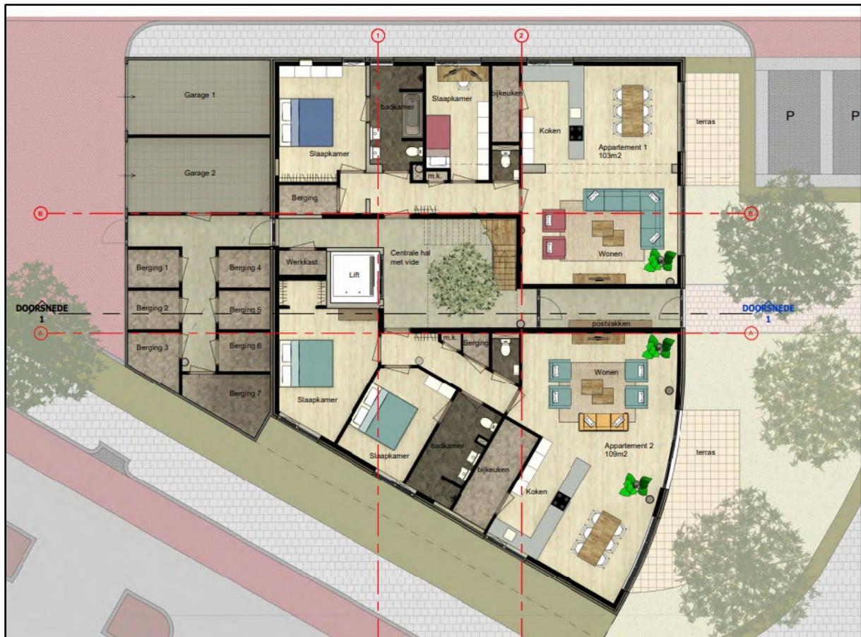
Afbeelding 3.1 Plattegrond begane grond (bron: Te Kiefte Architecten)
