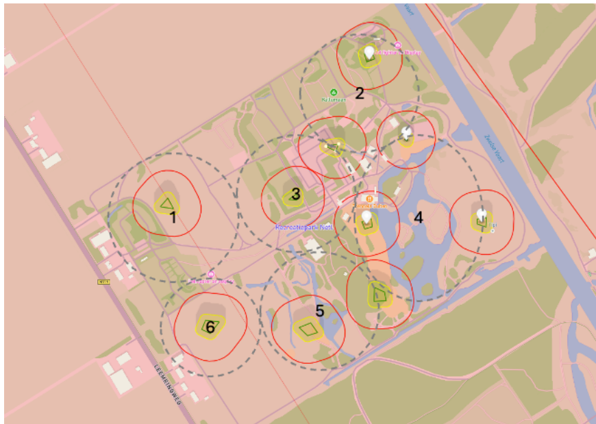
Figuur 1 een voorbeeld aantal assemblies op terrain met de minimale bufferzone van 60 meter
