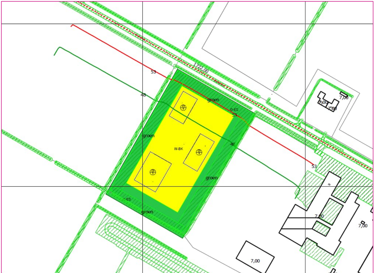
Figuur 2: overzicht van de berekende L_{den} = 48/53 dB geluidcontour vanwege de Voorsterweg op een waarneemhoogte h_o = +4,5 m (inclusief 2 dB aftrek o.b.v. artikel 110g Wgh)
